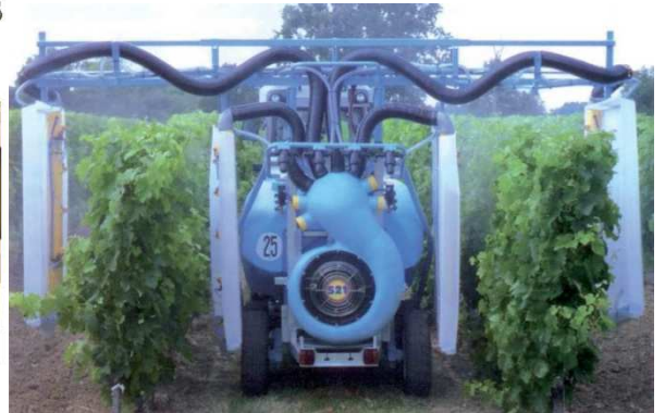
S21 - Tunnel de pulvérisation
