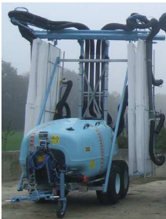
S21 – Tunnel de pulvérisation
